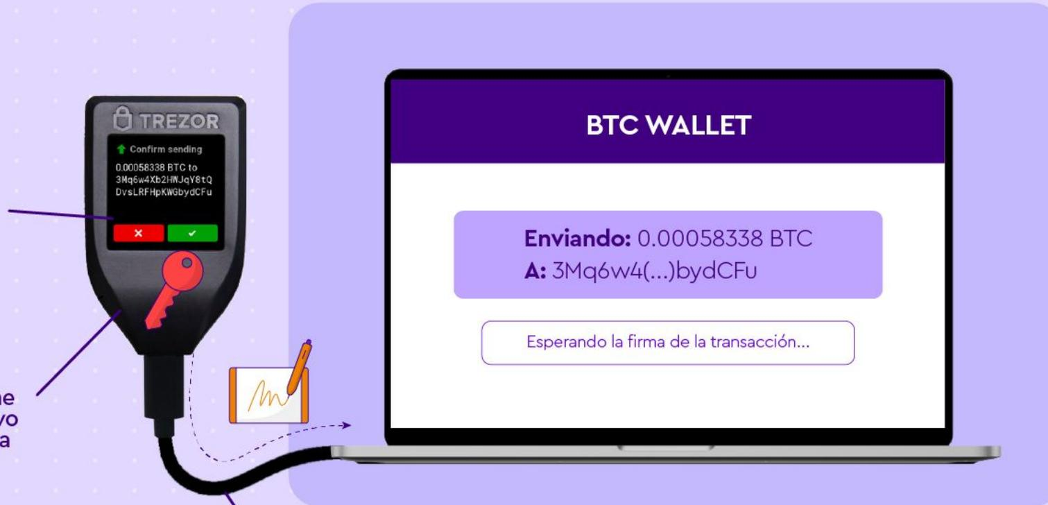
El dispositivo de hardware firma la transacción y solo envía esta firma hacia el software de la computadora que se encarga de enviar la transacción
